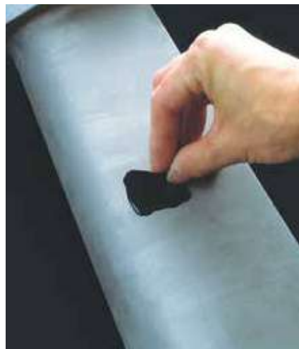
硬化したレプリセットは簡単にはがせます
