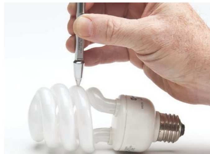
高分解能ソフトウェアオプションにより、最大分解能 0.001 mm の精密な肉厚測定が可能
