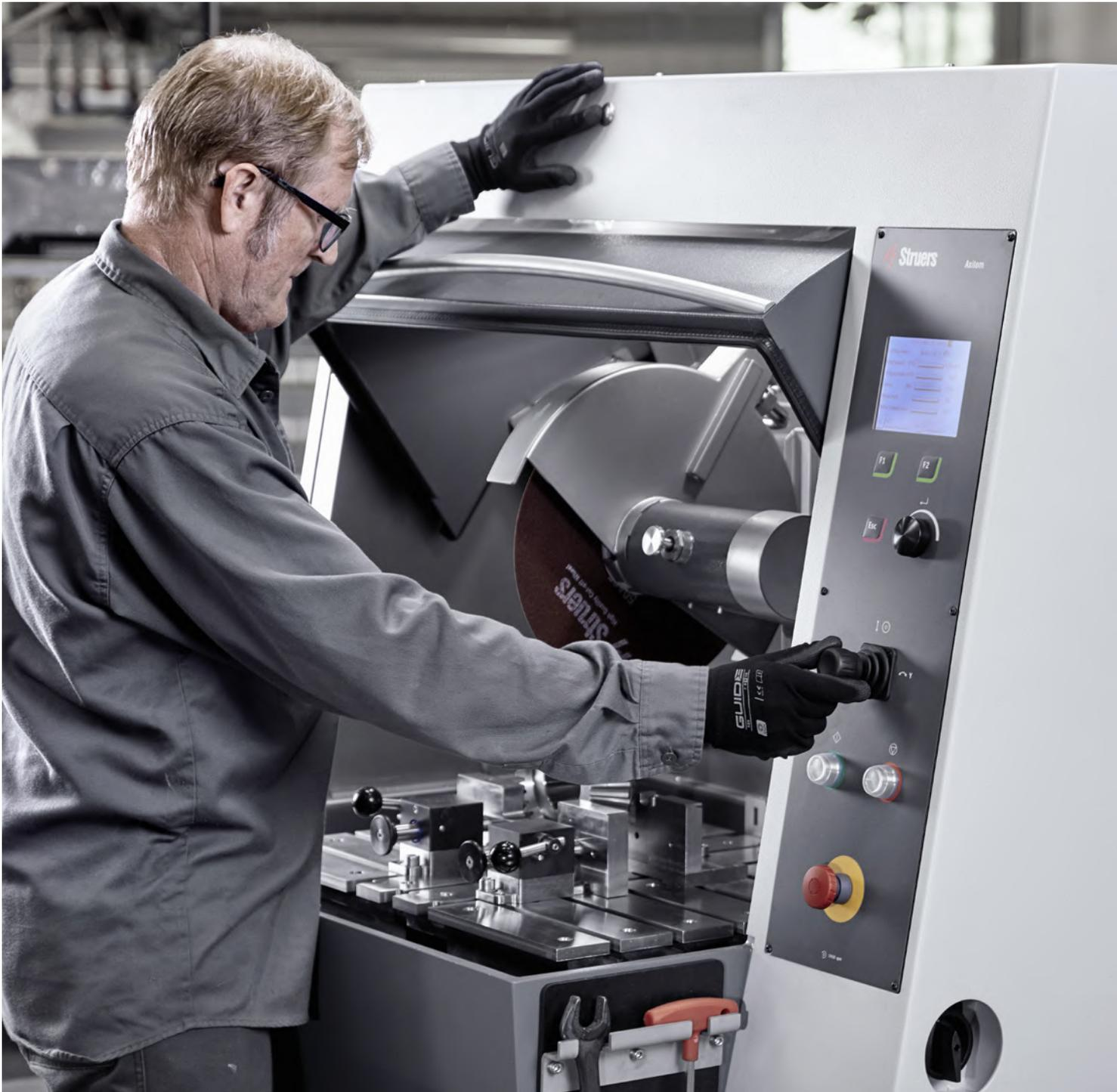
ズも同じ分量増加します。そのため、アキシトム-5/400は最大125 x 290 mm (4.9" x 11.4")、Axitom-5は最大110 x 245 mm (4.3" x 9.6")を処理できます。切断ホイールは上下に動き、試料との接触面積を最小限に抑え、過熱と熱損傷を防止します。
