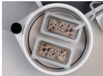
大型の試料に適した広々とした真空含浸室
