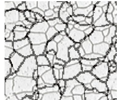
チャート比較 (フェライト結晶粒の微細組織)
