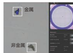
独自の光学技術により、金属 / 非金属を1スキャンで高速分類
