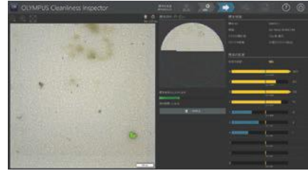
画像取得中にリアルタイムで粒子のクラス分類の確認が可能
