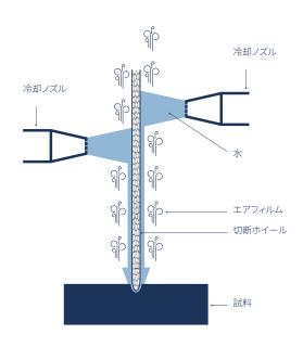
試料の両側にある2つの冷却ノズルにより、冷却水が切断ホイールの周囲の エアフィルムに浸透し、切断領域内で試料を効果的に冷却します。
