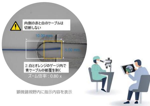
ズームに連動してゲージやレチクル、グリッドの大きさが変更されて顕微鏡視野内に投影されるので、作業に伴う顕微鏡の倍率変更にもスムーズに対応します。
